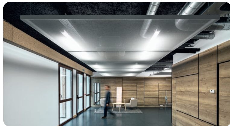
Constitué de panneaux ajourés Stereo Air, Strato vient unifier le plafond. Il masque les détecteurs de fumée et les bouches d'aération tout en laissant passer la lumière des systèmes d'éclairage. Gradignan, bâtiment Sauternes de Bordeaux Sciences Agro. Jean-Philippe Gras, architecte.
